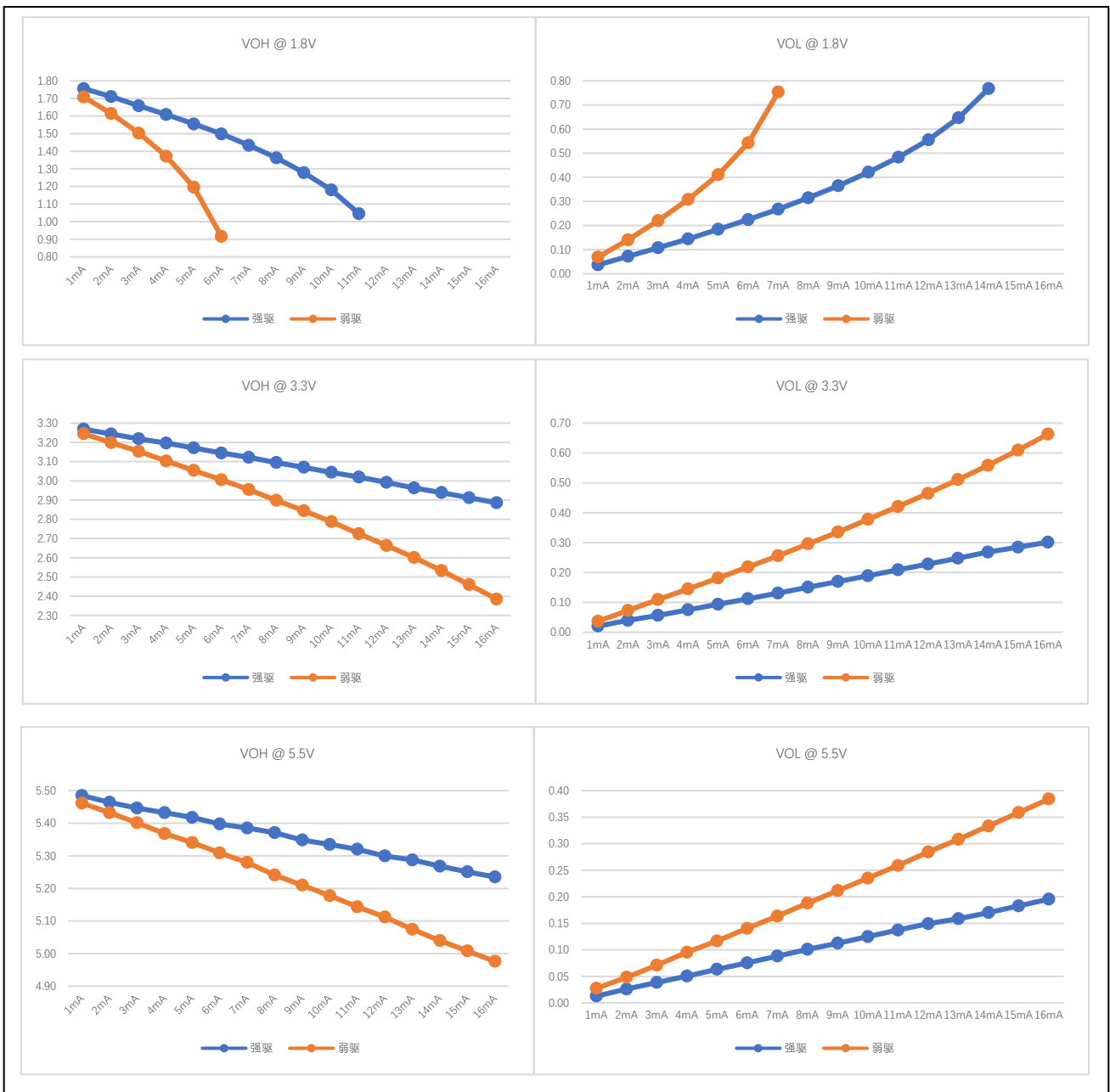
图 7-2 输出端口 VOH/VOL 实测曲线
